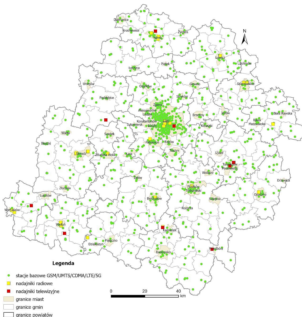
Rysunek 16 Źródła promieniowania elektromagnetycznego z zakresu 0,3 – 3 GHz na terenie woj. łódzkiego w 2023 r.
